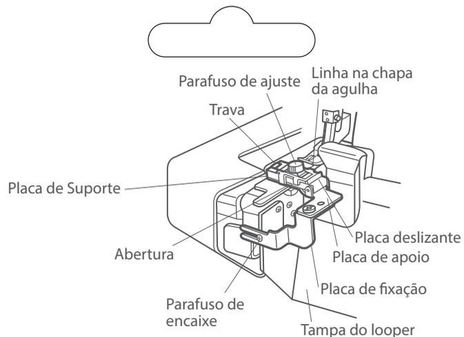
4. Posicione a fita de elástico na placa de suporte. (Alinhe a margem direita da fita com a linha na placa de suporte). Puxe cerca de 5cm da fita de elástico para trás, por baixo do calçador.
