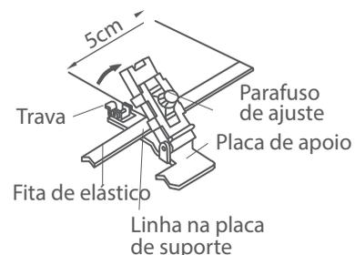
5. Feche a placa de suporte e prenda com a trava. Ajuste a placa deslizante de acordo com a largura da fita de elástico.
