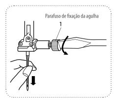
Coloque uma nova agulha no suporte de agulha com o lado plano (chato) voltado para trás.
