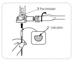
Quando inserir a agulha no suporte da agulha, empurre-a contra o pino limitador e aperte o parafuso de fixação da agulha firmemente com uma chave de fenda.
