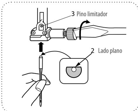
Quando inserir a agulha no suporte da agulha, empurre-a contra o pino limitador e aperte o parafuso de fixação da agulha firmemente com uma chave de fenda.
