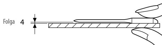
Para verificar se a agulha está reta, coloque o lado plano (chato) da agulha sobre algo reto (uma chapa de agulha, vidro, etc.).
